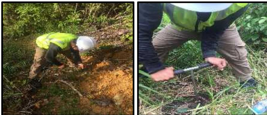
**Gambar 3.23 Pengambilan Sampel Tanah**
